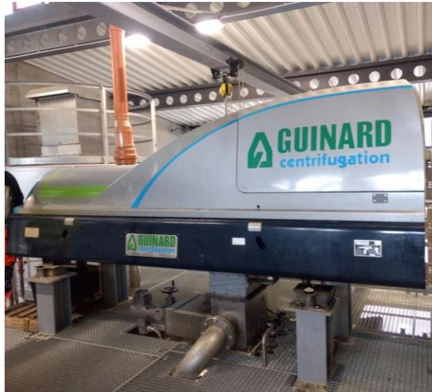
Abb. 9: Schlammwässerung (Zentrifuge)
